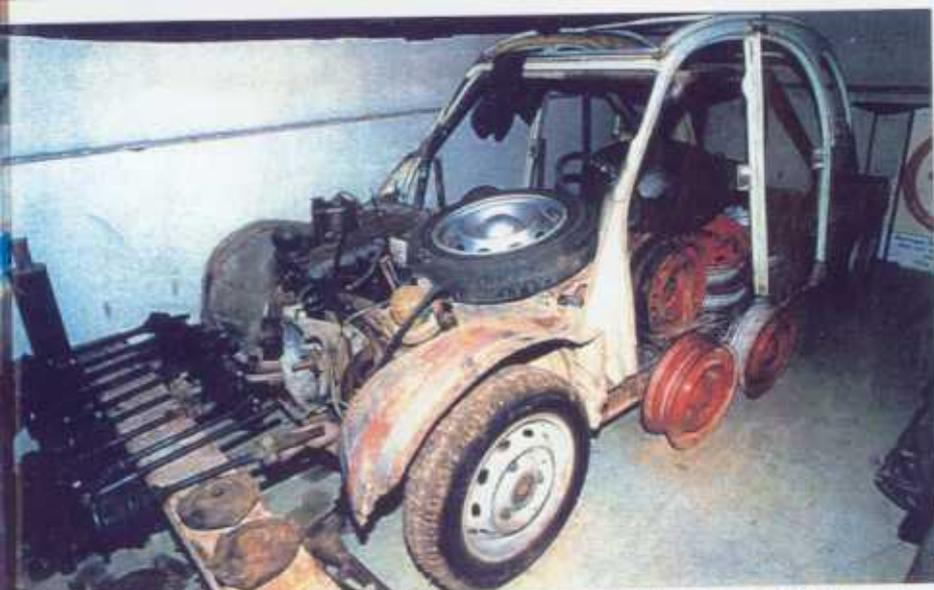
Pas encore terminée, cette caisse de 2 CV est greffée sur une plate-forme de GS 4x4 à compresseur développant 100 ch.
