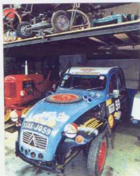
La 2 CV à double boîte de vitesses avec laquelle Amédée a fait le dernier Raid des Baroudeurs en Tunisie (voir Planète 2 CV n° 42). Le toit blanc est en tôle, car visiblement Amédée n'aime pas le sable à l'intérieur. Le capot se soulève laissant la roue de secours sur un dispositif fixé au châssis. En cas de besoin, les roues peuvent être jumelées à une paire d'autres roues par un système d'attaches spécial.
